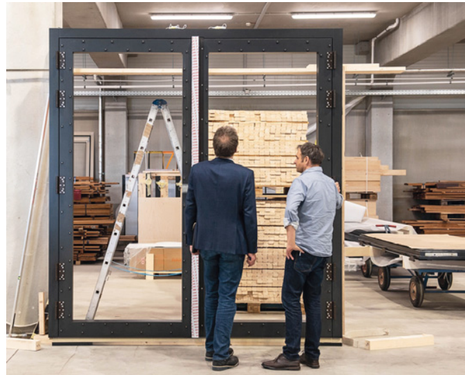
Abteilung Fassadenbau: Stabile Türelemente der John-Cranko-Schule des Stuttgarter Baletts als Holz-Alu-Konstruktion
