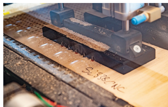
Rasterbohranlage für akustisch wirksame Werkstoffe aus Birkoplexplatten der Abteilung Sporthallenbau
