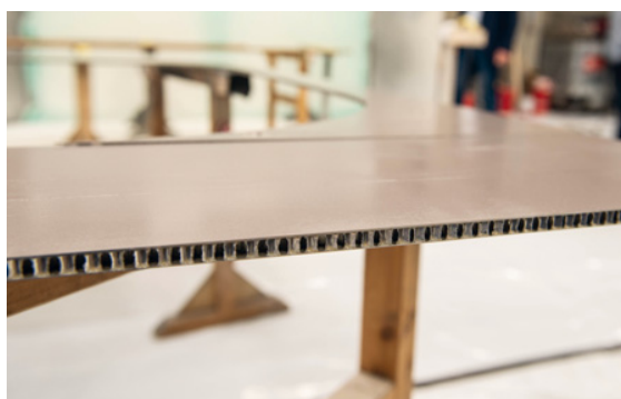
Schiffsinnenausbau: Aluminiumleichtbauplatten bieten Feuerwiderstand bei wenig Gewicht
